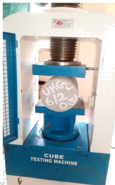
Fig.4. Split Tensile Test
